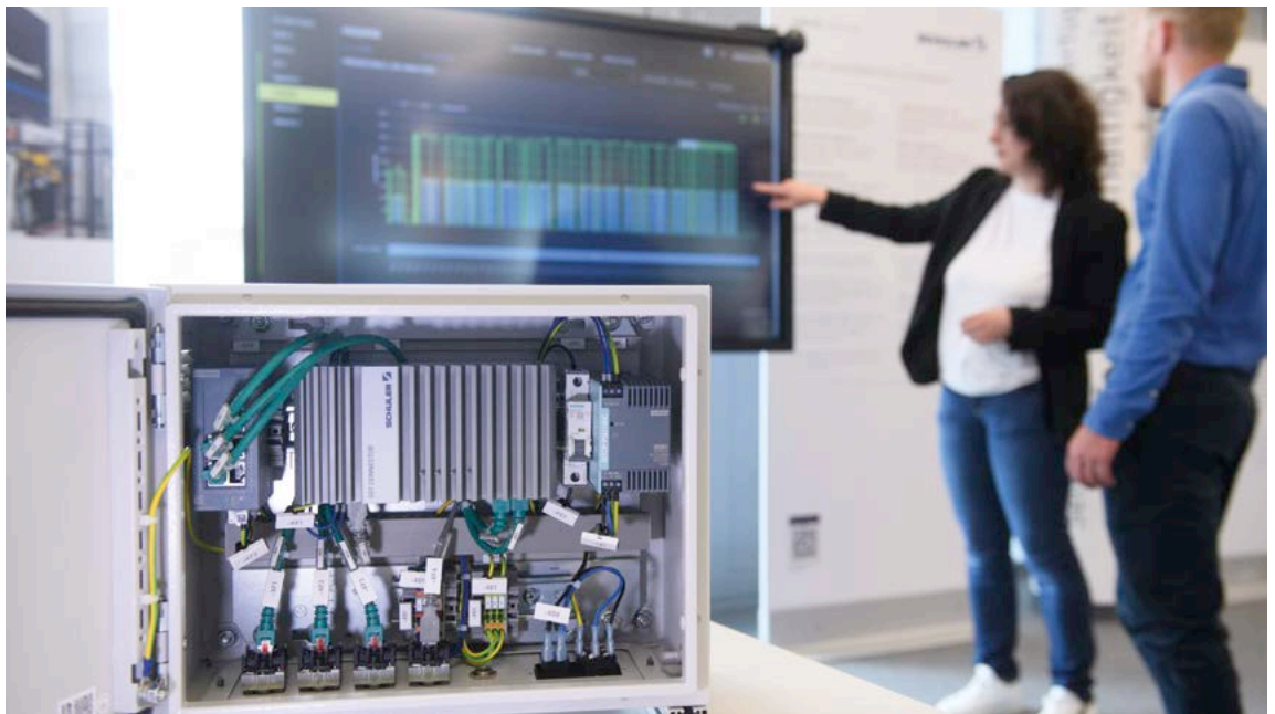
Edge in a Box: Die gesamte Systemhardware wird in einem Schaltschrank vorkonfiguriert und muss beim Anwender nur noch angeschlossen und aktiviert werden. „Schuler-Lösung für Industrial Edge“
